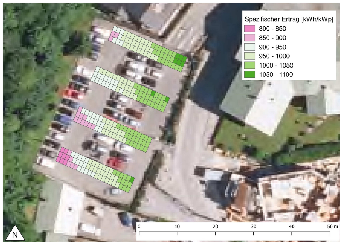
Abbildung 32: Detailprojekt: Ergebnis der Ertragssimulation für maximale Modulbelegung
