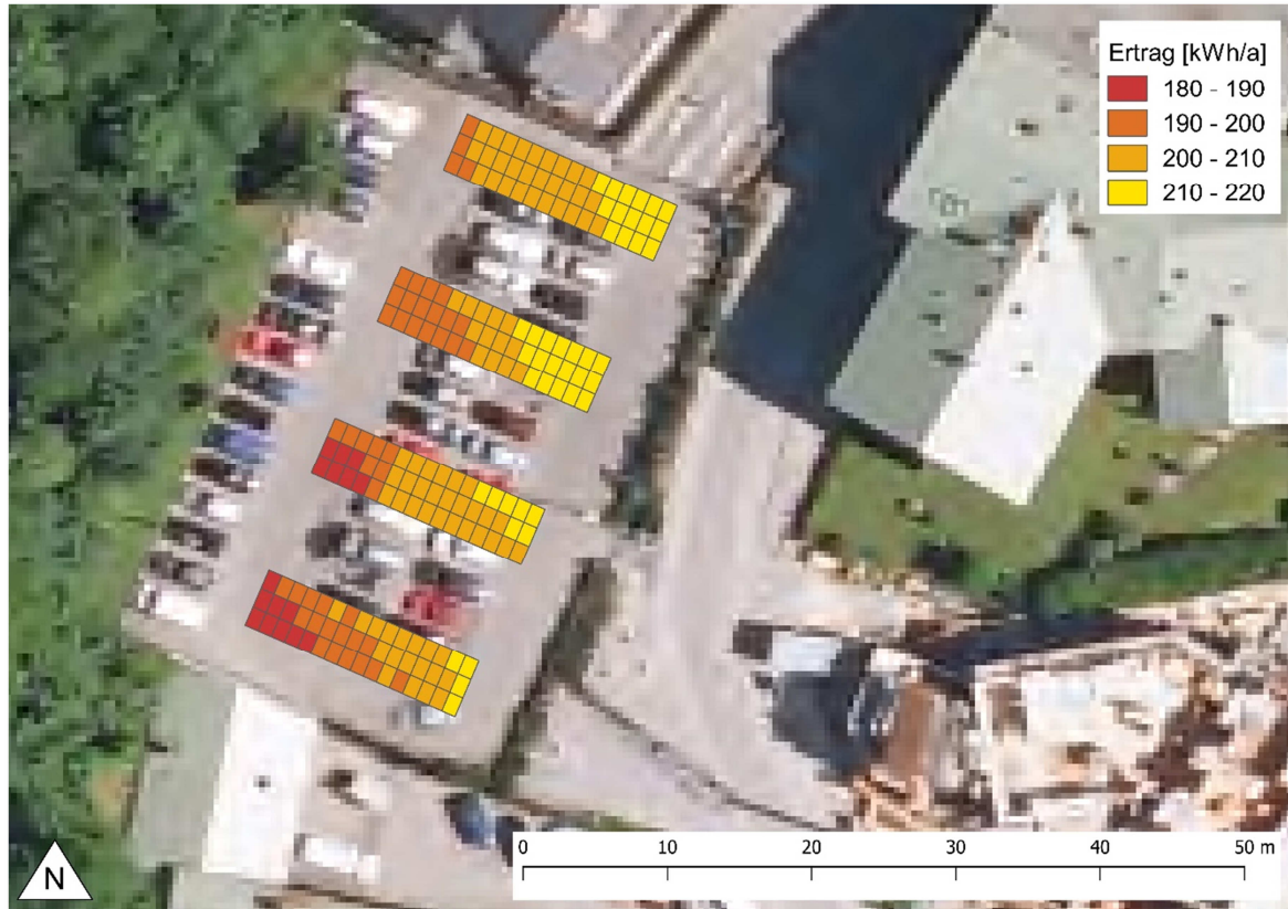
Abbildung 33: Detailprojekt: Jährlicher Stromertrag pro Photovoltaikmodul
