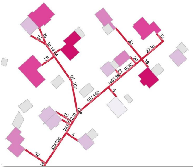
Abbildung 5: Schematische Darstellung zur Ermittlung der Wärmebelegungsdichte auf (theoretischen) Trassenabschnitten
